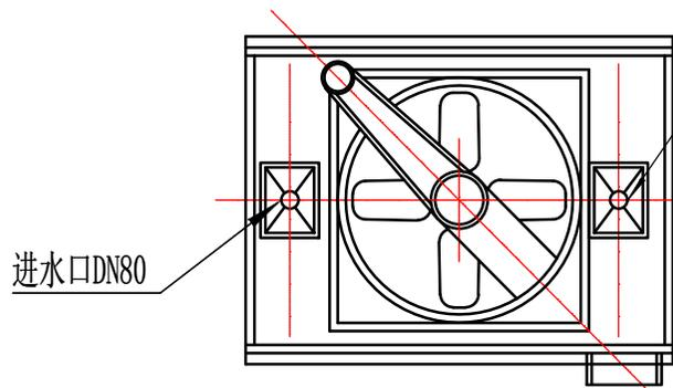
特别说明：20T制冰机配套冷却水量为40立方/小时就能满足使用，由于良机没有40立方/小时的规格，只有30、50立方/小时的。
